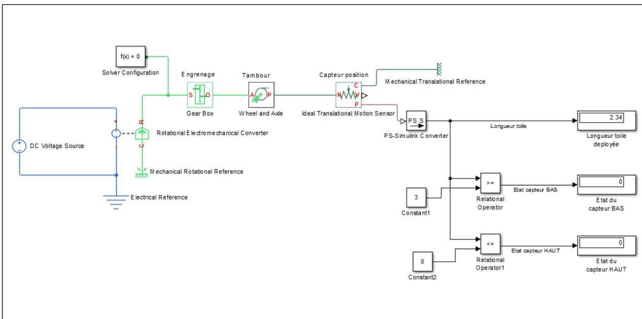
On peut calculer le déplacement de la toile du store pour une durée de simulation de 20s. En effet, le moteur alimenté sous 12V tourne à 1600tr/min, soit en 20s : 533,33tr. Après le réducteur, le tambour tourne 100 fois moins vite soit 5,33tr.
