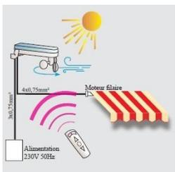
On peut trouver des équipements qui réalisent plusieurs fonctionnalités en un seul boîtier. Ci-contre, c'est un module qui mesure la vitesse du vent et l'intensité lumineuse.
