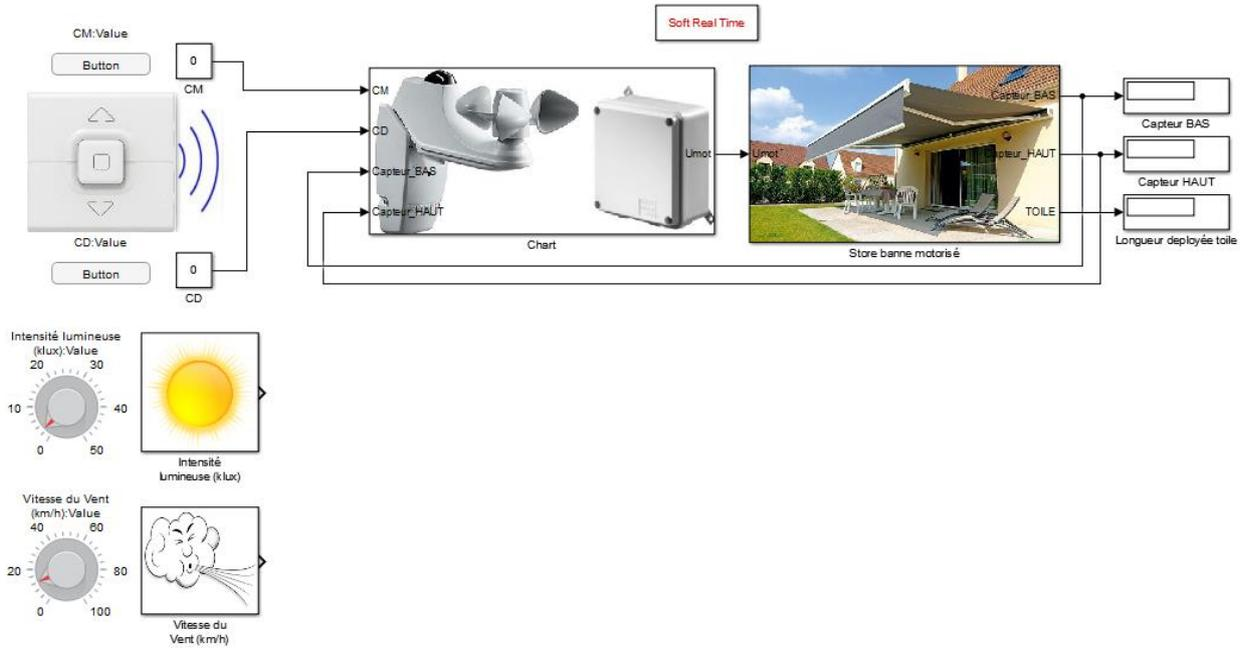
Vous pouvez remarquer que sur ce modèle Simulink, les deux boutons rotatifs qui permettent de simuler des « conditions météorologiques » ne sont pas connectés au « Chart ». De plus, on notera qu’aucune entrée n’est déclarée afin de récupérer les valeurs de ces grandeurs physiques dans le diagramme d’état.
