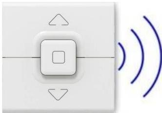
Le store banne électrique est équipé d'un module sans fil - *trois boutons poussoirs* - qui permet le pilotage à distance. On rappelle que les capteurs BAS et HAUT du store banne permettent de détecter les positions limites. Soit respectivement, toile déroulée au maximum et toile totalement enroulée dans le coffre.
